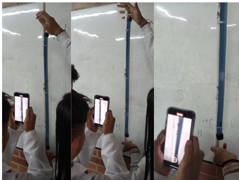
Ilustración 16 Time lapse de la caída de varias esferas dentro de un tubo con jabón. Elaboración propia.
