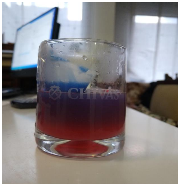
Mezcla de porciones de agua salada a diferentes temperaturas una vez entran en
