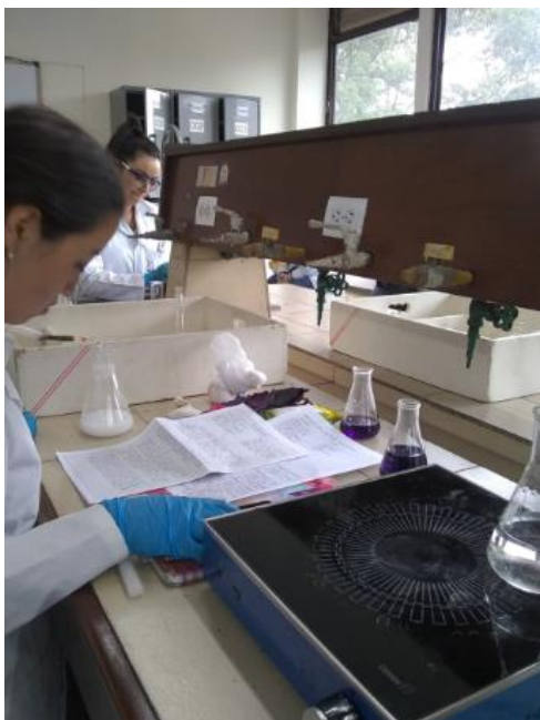
Figura 9. Síntesis de nano partículas de plata por química verde con extracto de geranio común PQFI-6 y PQFI-7. Fuente: autoras.
