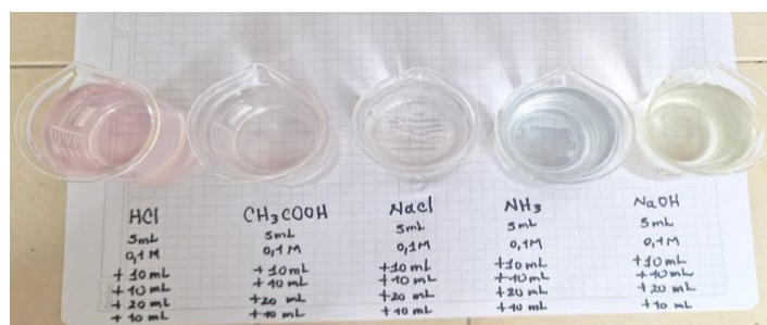
Imagen 18. Soluciones de 55 mL de HCl, CH 3 COOH, NaCl, NH 3 y NaOH al 0.009M con 10 gotas de indicador de Saúco. Elaboración propia.
