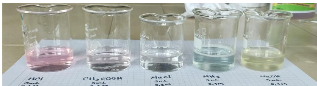
Imagen 15. Soluciones de 15 mL de HCl, CH 3 COOH, NaCl, NH 3 y NaOH al 0.033M con 10 gotas de indicador de Saúco. Elaboración propia.
