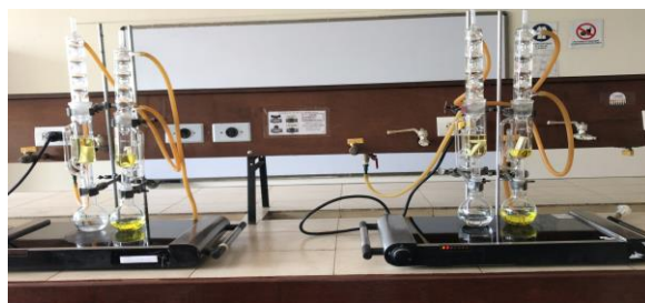
Ilustración 30 Inicio de proceso soxhlet especie con espina nivel 4 y 5 de maduración
