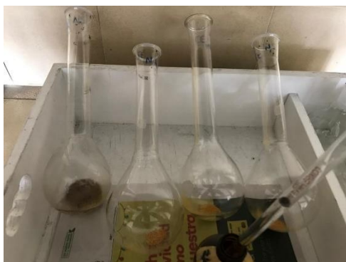
Ilustración 20 Balones Kjeldahl con la mezcla para llevar al digestor.
