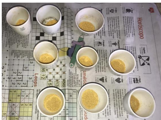
Ilustración 38 Muestra de cáscara de lulo en crisoles previo a la carbonización
