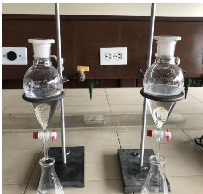
Ilustración 46 Separación por método de decantación.
