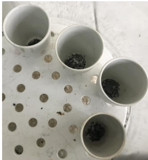
Ilustración 37 Cenizas obtenidas en el proceso de determinación de fibra
