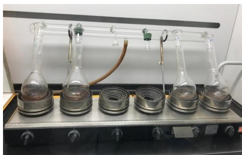
Ilustración 21 Balones Kjeldahl en el digestor.
