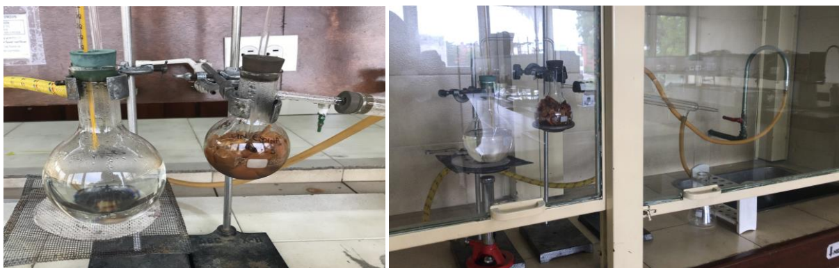
Ilustración 44 Montaje de extracción agua + aceite por arrastre a vapor.
