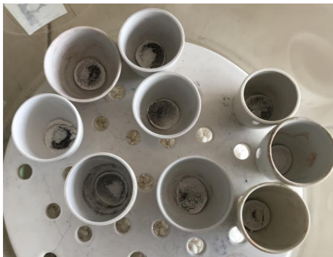
Ilustración 41 Resultado final de obtención de cenizas
