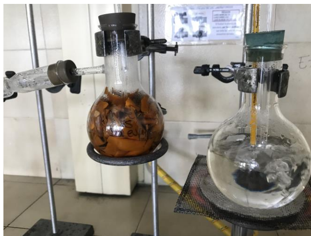
Ilustración 44 Montaje de extracción agua + aceite por arrastre a vapor.
