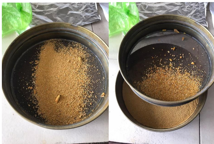
Ilustración 18 Proceso de tamizado a 1 mm.
