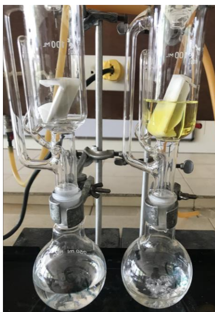
Ilustración 29 Inicio de proceso soxhlet especie con espina nivel 4 y 5 de maduración
