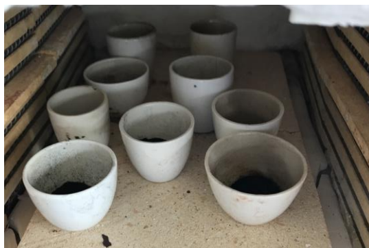
Ilustración 40 Inicio del proceso de incineración en mufla.
