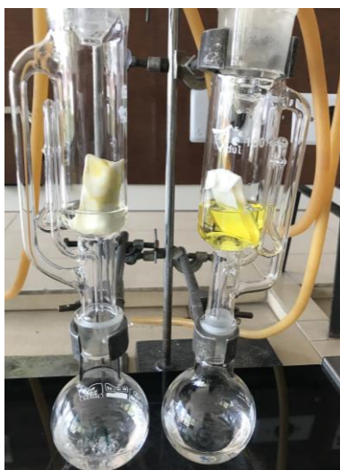
Ilustración 28 Inicio de proceso soxhlet especie sin espina nivel 4 y 5 de maduración
