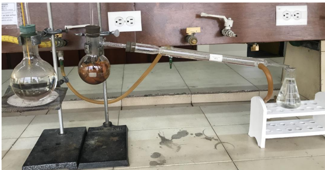
Ilustración 42 Montaje de extracción agua + aceite por arrastre a vapor.
