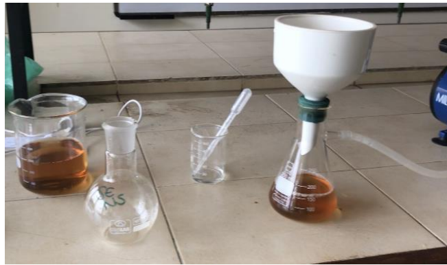
Ilustración 35 Filtración de la hidrolisis
