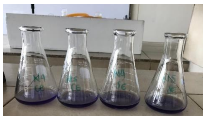
Ilustración 22 Solución de ácido bórico al 4% e indicador tashiro para recoger el destilado.
