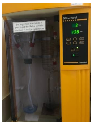
Ilustración 24 Destilación en equipo Kjeldahl.
