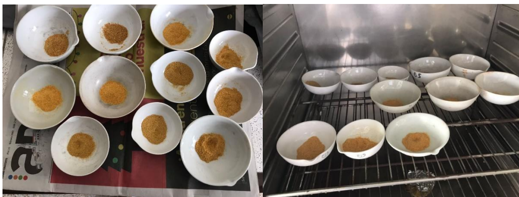
Ilustración 19 Determinación de porcentaje de humedad y sólidos totales en cascara de lulo especie con y sin espina nivel 4 y 5 de maduración.
