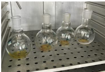
Ilustración 31 Balones con la extracción obtenida para iniciar proceso de secado de pequeñas trazas de solvente
