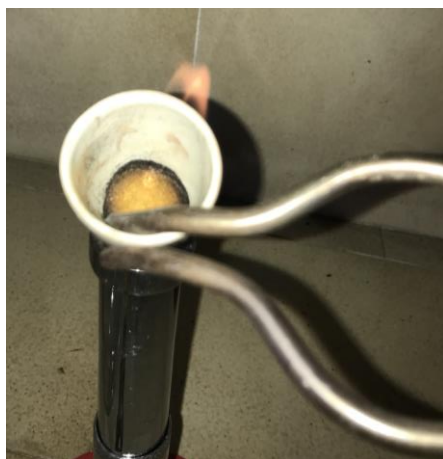
Ilustración 39 Carbonización en mechero.
