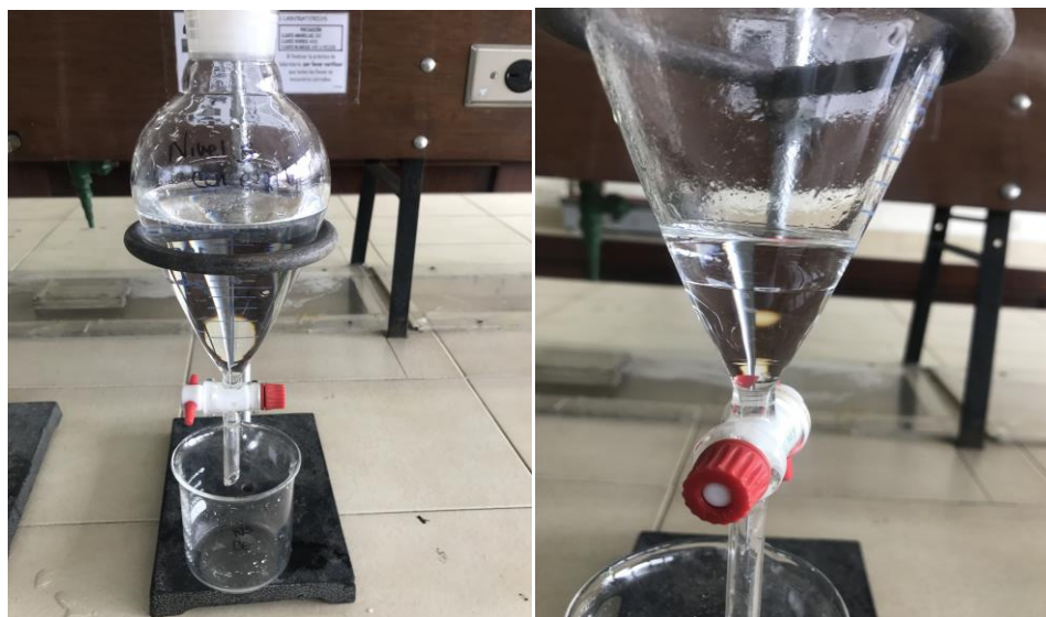
Ilustración 47 Separación por método de decantación.
