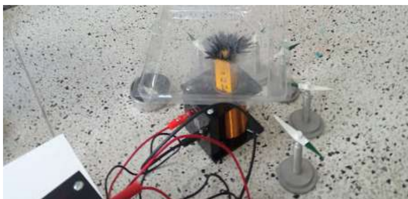
Imagen 12: Montaje experimental del electroimán con visualización de campo magnético en las limaduras y las brújulas
