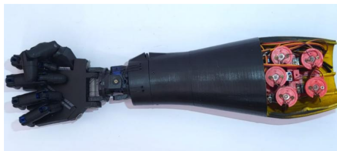
Ilustración 20. Brazo ensamblado y pintado
