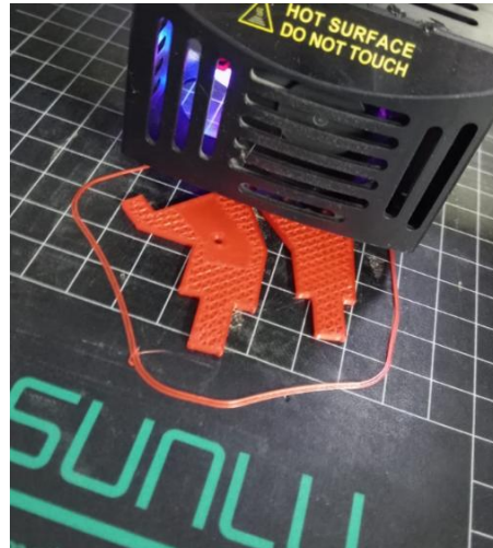
Ilustración 6. Impresión de las articulaciones de los dedos anular y meñique
