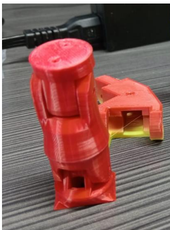
Ilustración 11. Dedo pulgar lijado y ensamblado.
