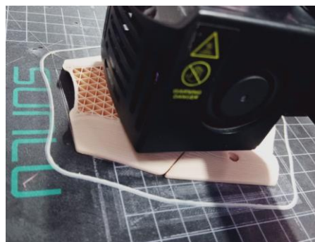
Ilustración 9. Impresión de la capa de arriba de la mano
