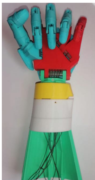
Ilustración 15. Mano ensamblada con antebrazo y muñeca
