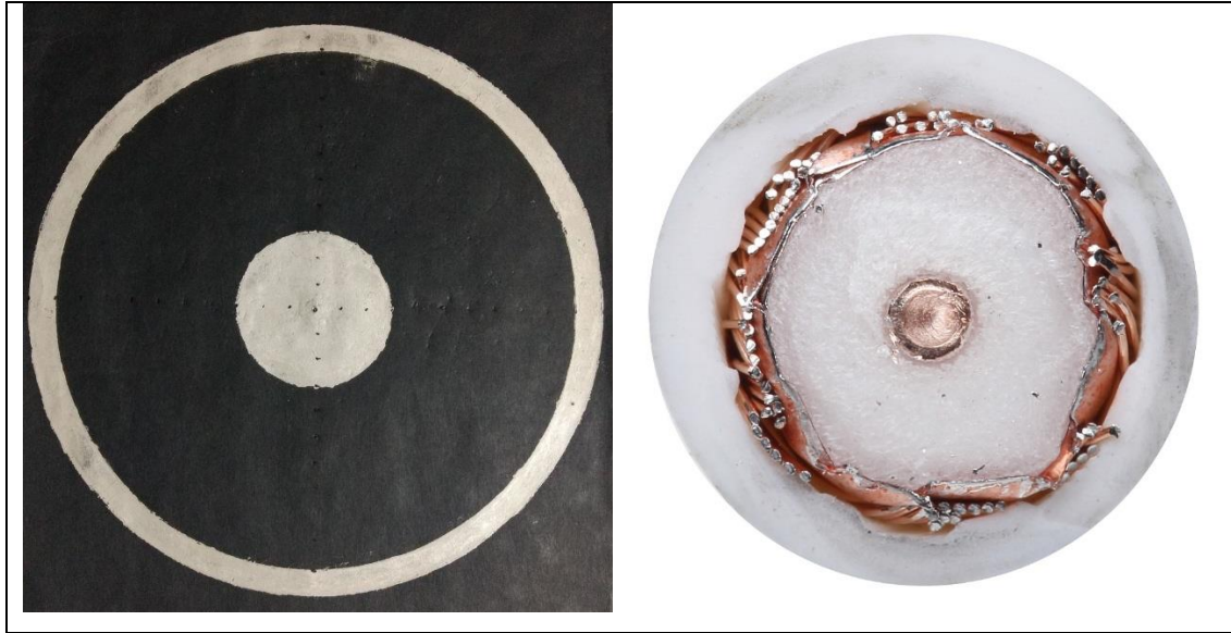
Figura 33: Fotos de un papel conductor(izquierda) y de un corte transversal de cable coaxial(derecha)
