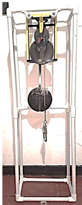
Imagen 42. Montaje de la estructura del reloj de péndulo.
