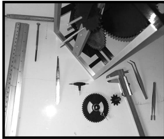
Imagen 35. Ensamble de piezas del reloj de péndulo, tren de engrane principal; al lado algunas herramientas utilizadas para su construcción (vernier, regla, pinzas y destornilladores). Imagen propia.
