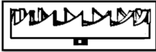
Imagen 10. La rueda de escape tipo verja (también conocida como escape de paletas verticales con dientes tipo sierra) fue el primer mecanismo que transformó el movimiento continuo de las pesas o resortes en un movimiento intermitente y regulado, permitiendo que el reloj “tictaqueara”. Imagen propia.
