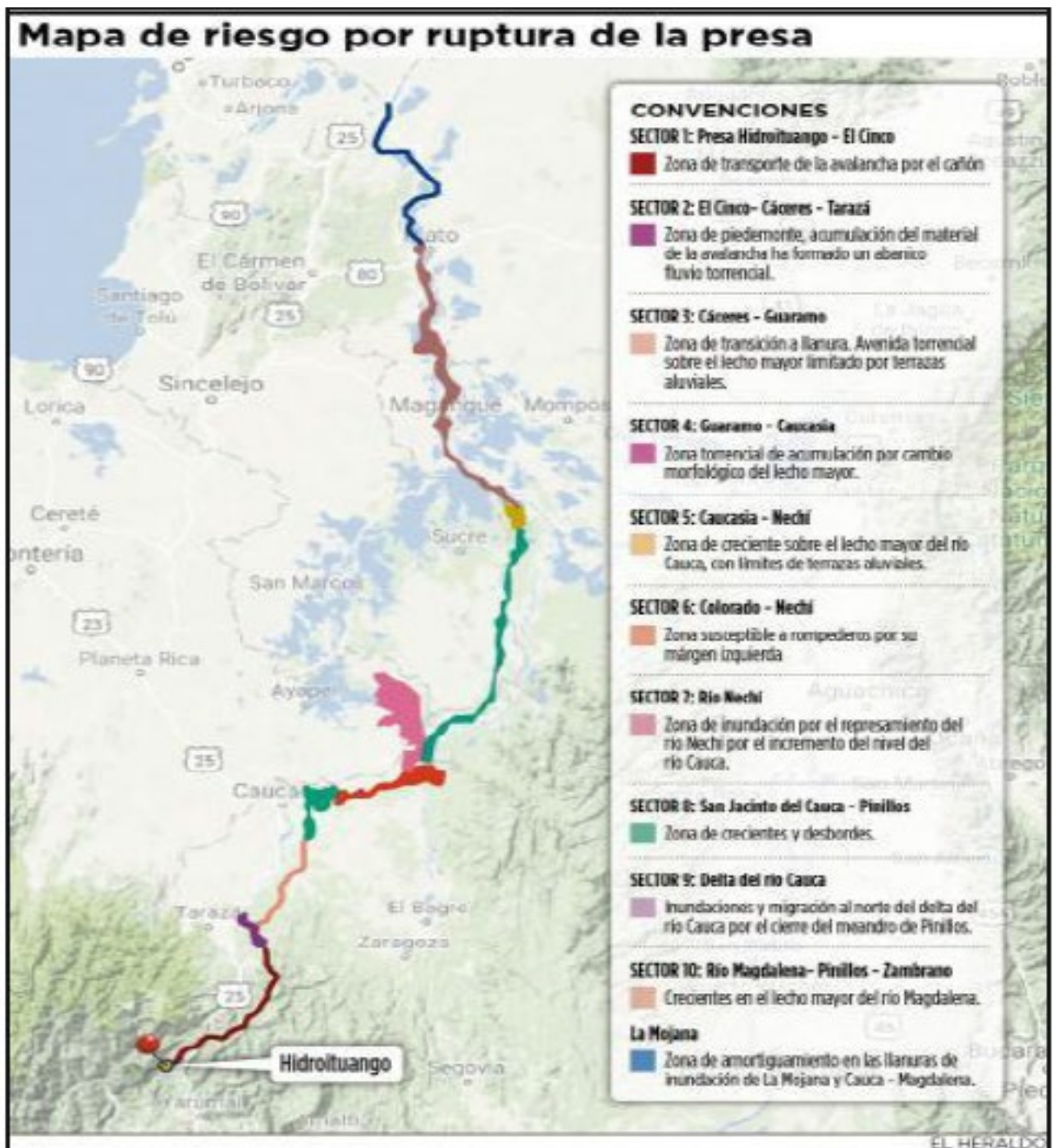
Mapa 6. Zona de riesgo por ruptura de la presa de HidroItuango
