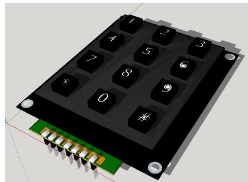
Figura 6: Diseño del teclado matricial en Sketchup
