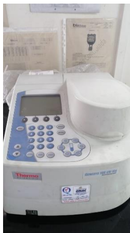
Ilustración 9 Espectrofotómetro GENESYS 10S UV - Vis
