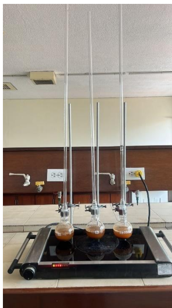
Ilustración 7. Montaje de Hidrólisis
