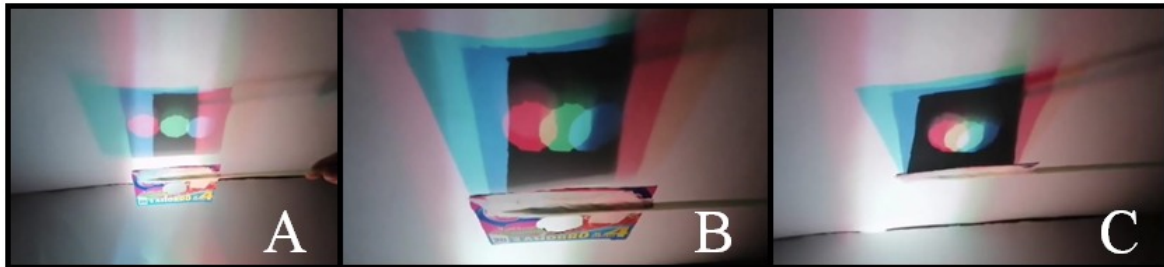
Imagen 23. Fotografías de los experimentos con linternas y un trozo de cartón con un orificio circular, donde apuntan las fuentes de luz con filtros de color (rojo, verde y azul). Fuente: elaboración propia.
