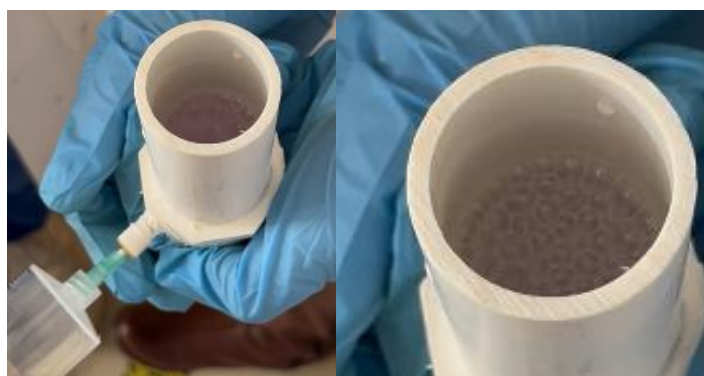
Fotografía 14 Viraje de la fenolftaleína en contacto con el dióxido de carbono. Experiencia 1. Montaje 2. Elaboración propia.
