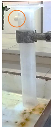
Fotografía 2 Probeta adaptada para la extracción de gases. Elaboración propia.
