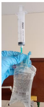
Fotografía 9 Inyección del dióxido de carbono en la bolsa, para la absorción en el agua. Elaboración propia.
