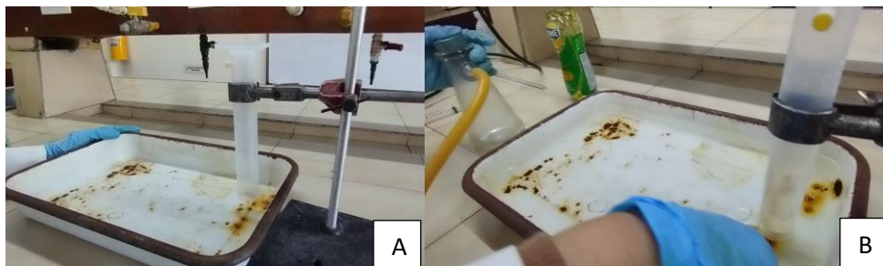
Fotografía 7 A: Montaje: Trampa para gases. B: Producción de CO 2 . Elaboración propia.
