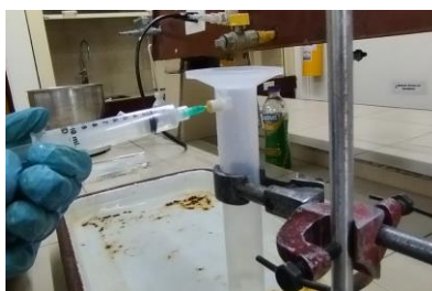
Fotografía 8 Extracción del dióxido de carbono de la trampa para gases. Elaboración propia.
