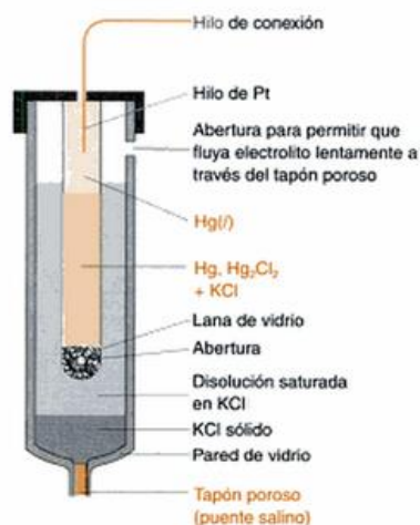
Figura 3. Electrodo de calomelanos saturado. Tomado de Harris (2003).
