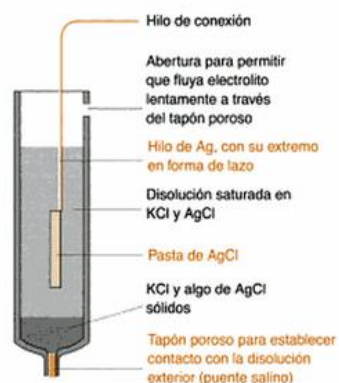
Figura 2. Electrodo Plata/Cloruro de Plata. Tomado de Harris (2003).
