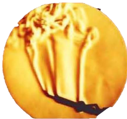
Figura 6. Estrioscopia Schlieren del aire calentado por un caudín.
