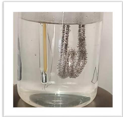
Imagen 7. Formación de burbujas sobre la resistencia eléctrica.
