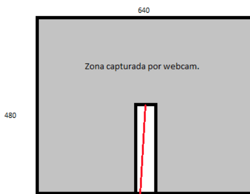
Figura 27. Posible desviación del láser en zona capturada.
