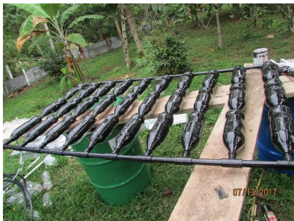
Figura 23. Armando la estructura interna del Colector
