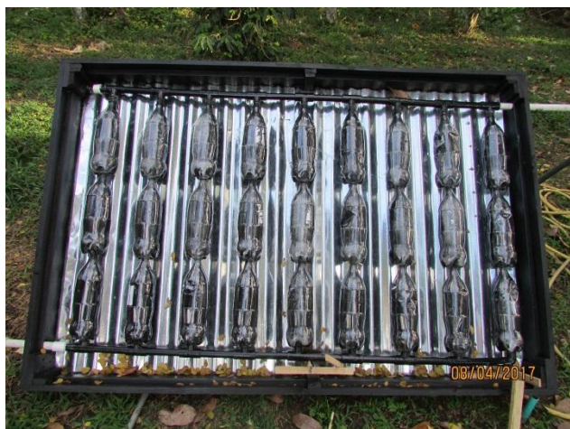
Figura 19. Colector dentro de la base
