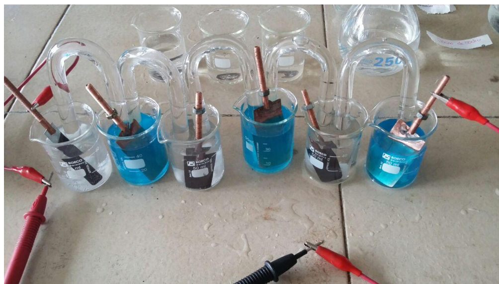
Figura 18. Fotografía montaje experimental dos conductores líquidos
