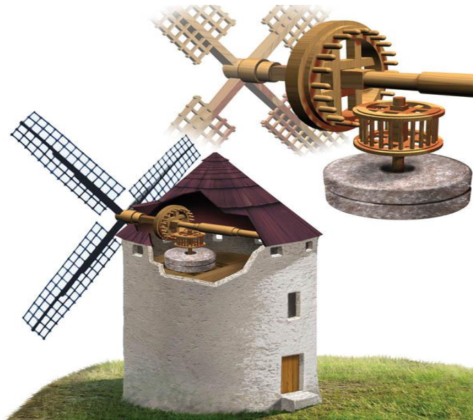
Figura 3 Salom C.(2016). Transmisión de la fuerza del viento a los engranajes de un molino. [Ilustración] Recuperado de http:// http://www.salomart.com
