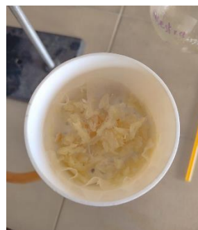
Imagen 22. Filtración del sólido de pergamino de café (Muestra 1)
