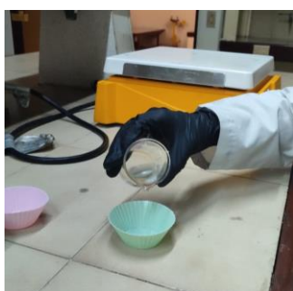
Imagen 40. Vertimiento de la solución de control de película mezclada PVA/Glicerol
