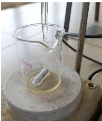
Imagen 34. Solución de celulosa antes de la adición de solución regeneradora.
