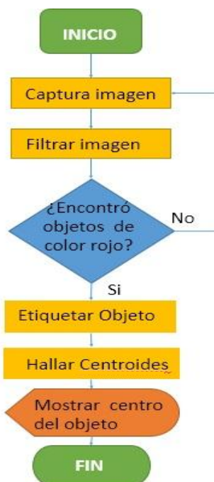
Figura 43 Diagrama de flujo para el seguimiento de objetos rojos Fuente: Autor.2016.Diagrama del sistema de visión artificial para ubicar objetos. [Fuente]
