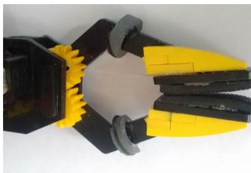
Figura 17 Pinza para recolección de objetos con motor D.C Fuente: Autor. 2016. Pinza del robot recolector [Figura]
