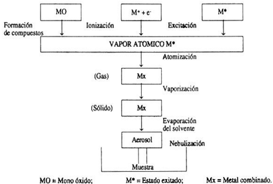
Figura 3. Diagrama del proceso de atomización en una llama. Tomado de Razmilic, s.f.
