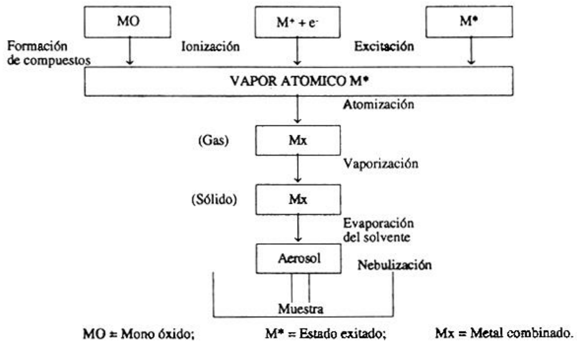
Ilustración 8. Diagrama del proceso de atomización en una llama. Tomado de Razmilic, s.f.
