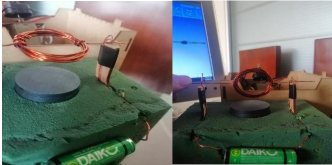
Ilustración 2. prototipo 2: motor eléctrico con una Fem externa
