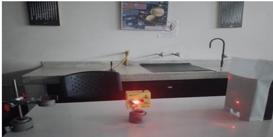
Ilustración 13. Recorrido de la luz láser en medio aire. Fuente: elaboración propia.
