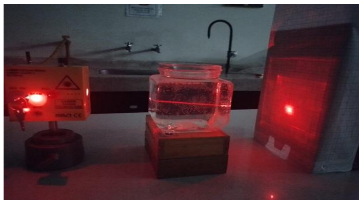
Ilustración 16. Recorrido de la luz láser en medio aire- agua-aire. Fuente: elaboración propia.
