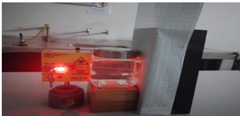
Ilustración 14. Recorrido de la luz láser en medio agua. Fuente: elaboración propia.
