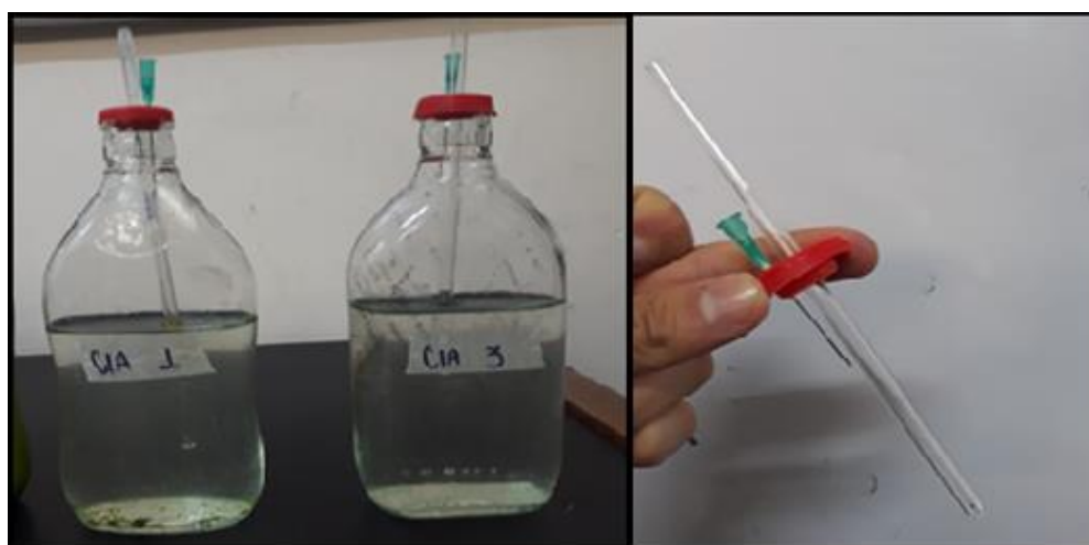
Figura 8. Nuevos medios de cultivo que poseen la cepa de microalga (izquierda) y los materiales que le permitirán la entrada y salida de gases (derecha). (Elaboración propia)
