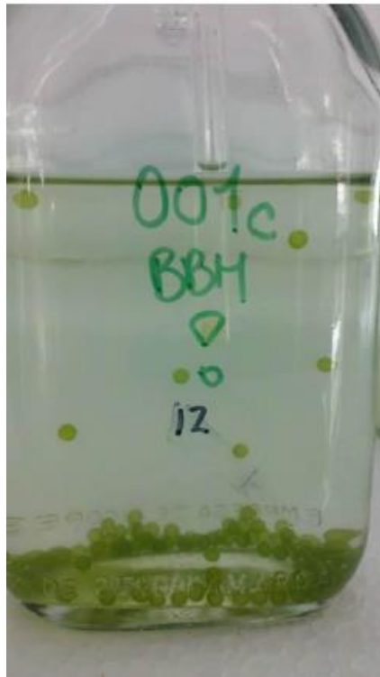
Figura 14. Capsulas de alginato con solución algal en botellas de cultivo Fed-batch (Delgadillo, 2014)
