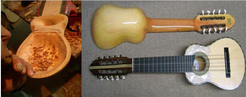
Imagen 8- Vaciado de un charango en madera y charango vaciado terminado.
