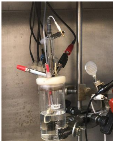
Ilustración 4. Montaje de la celda electroquímica empleada para la síntesis y caracterización de películas de polipirrol sobre acero 1020.
