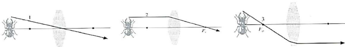
Ilustración 11. Fuente: (Hecht & Zajac, 2000) Trazado de rayos para la formación de imagen en la lente convergente.
