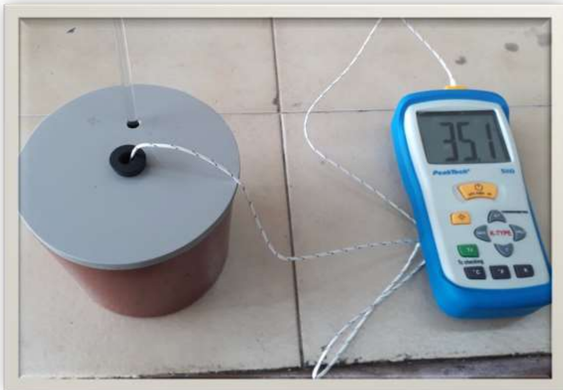
Figura 8. Termocupla K y parte exterior del calorímetro, empleados para el abordaje de las reacciones de la fase dos del trabajo de grado
