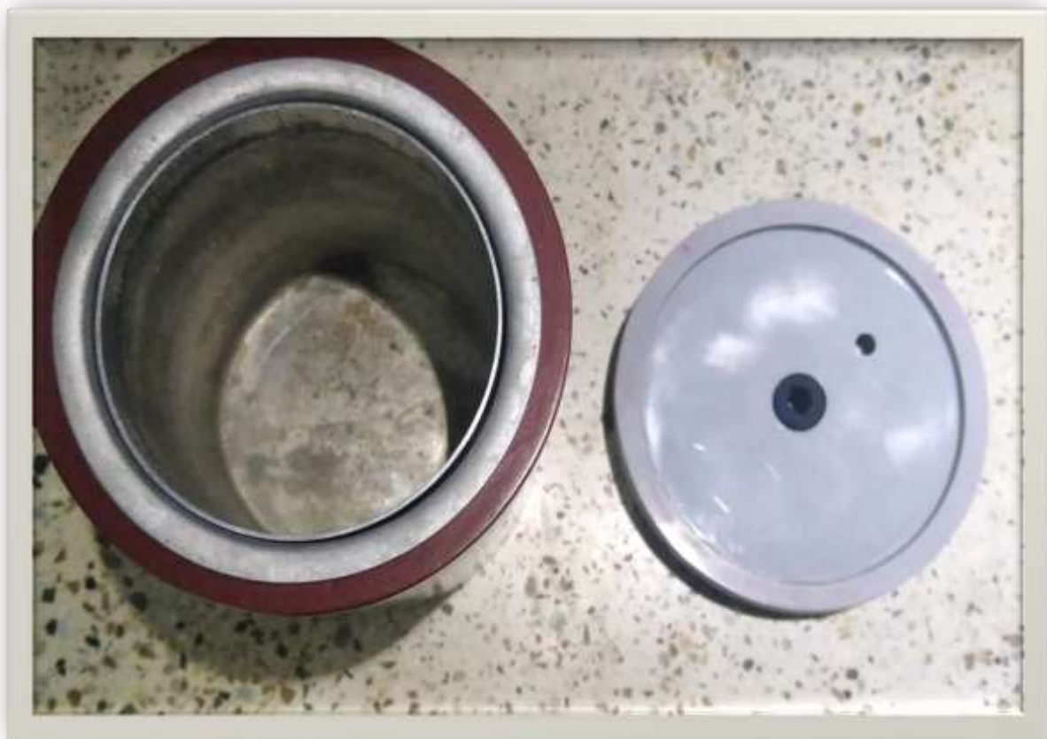
Figura 9. Compartimiento interior del calorímetro, empleado para el abordaje de las reacciones de la fase dos del trabajo de grado
