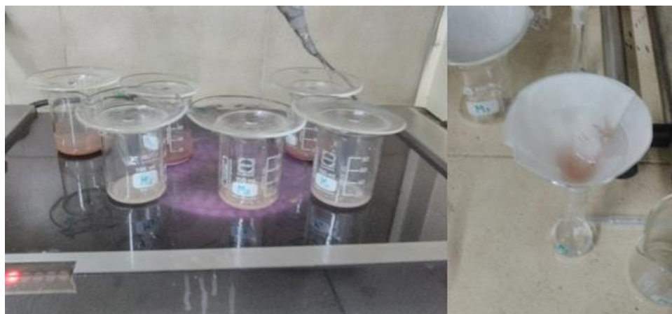
Imagen 4. Preparación de muestras (digestión y filtrado)
