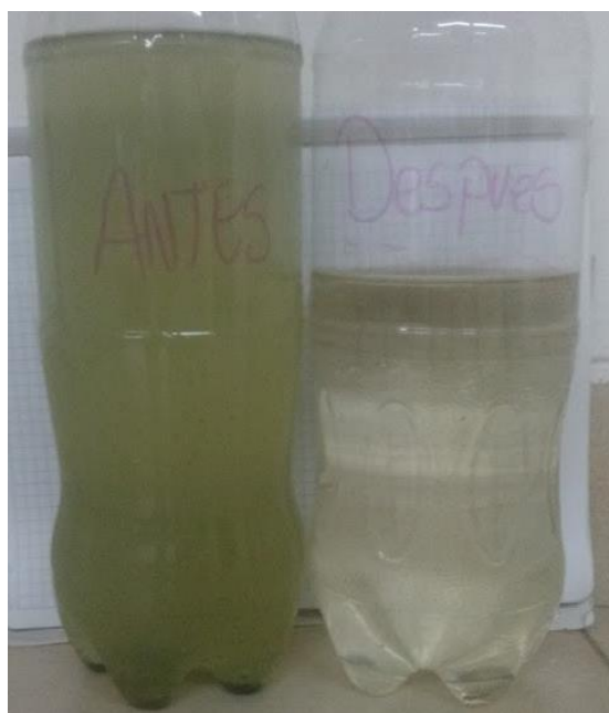
Imágen 1. Muestras de agua del Humedal antes y después de pasar por el biofiltro
