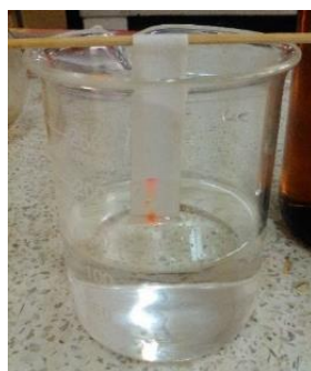
Grafica 4: Cromatografía en papel, tomado en laboratorio institucional, (2017)
