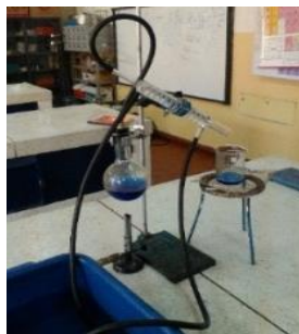
Grafica 1: Montaje para destilación simple, tomada en laboratorio institucional, (2017)
