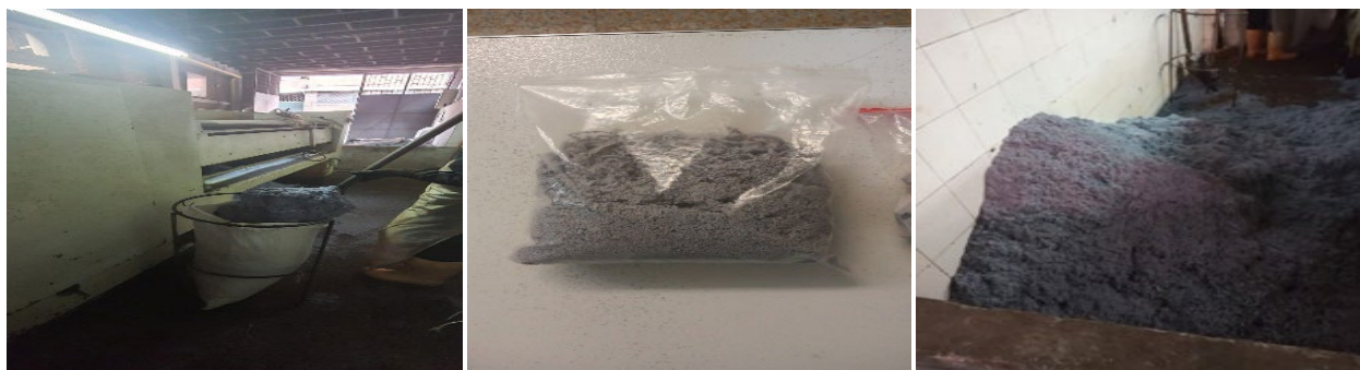
Figura 2. Residuos derivados del proceso de rebajado de las pieles azuladas: virutas del WB
