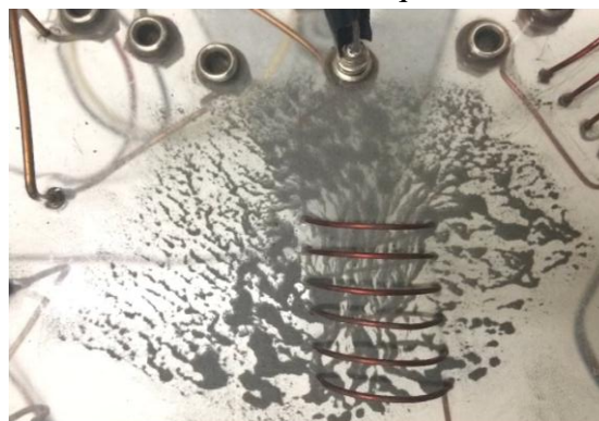
Imagen 5. Formación de la limadura de hierro luego de encender las bobinas.
