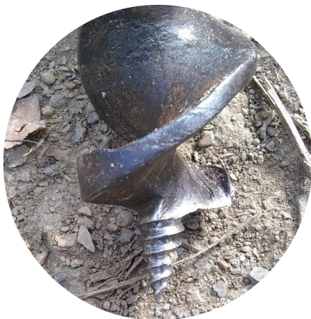
Ilustración 46. El tornillo de avance. Fuente: propia; Fecha: 03/05/2019.
