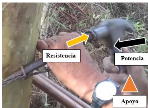
Ilustración 22. El martillo como palanca de tercer grado. Fuente: propia; Fecha: 01/05/2019.
