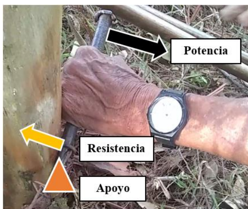
Ilustración 23. El desgrampador: palanca de segundo grado. Fuente: propia; Fecha: 01/05/2019.
