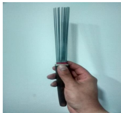
Figura 8 , gancho o tranche terminado, en este caso, el mango es de madera de caoba. Foto tomada el 1 de septiembre de 2015
