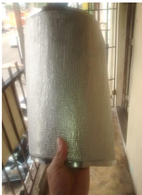
Figura 3, Lámina de acero níquel picada y lista para convertirse en güira. Foto tomada el 31 de julio de 2015
