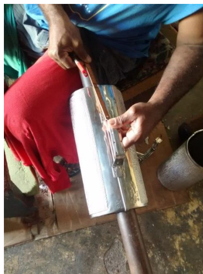
Figura 6 , tomando medidas antes de asegurar el puño . Foto tomada el 1 de septiembre de 2015
