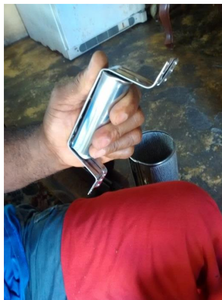
Figura 4, El puño o asa, con la forma que Guillermo soñó, y que revolucionó la manera de fabricar güiras. Foto tomada el 31 de julio de 2015.
