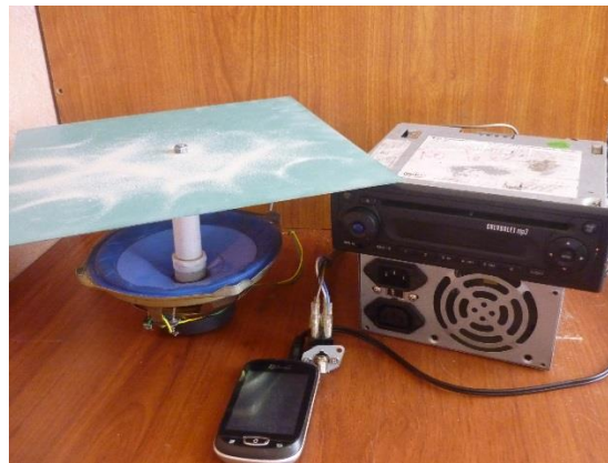
Figura 2: El modo en el cual, El bafle está sujetando con una base a la placa de acero, donde se observa el cable del bafle que está conectado a un amplificador. Para más detalles ver el (Anexo 3.3).
