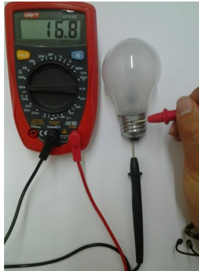
Imagen 6. Determinar la resistencia ambiente
