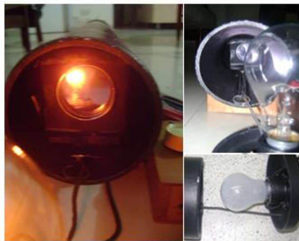
Figura 5. Zona interna del montaje experimental
