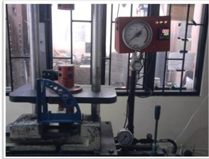
Ilustración 29 máquina de tensión adaptada para la prueba de flexión, Universidad Pedagógica Nacional
