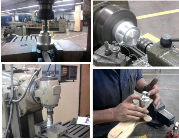
Ilustración 53 proceso de fabricación del adaptador
