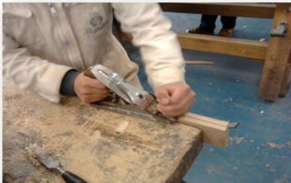
Ilustración 47 Proceso de extracción de chapilla de guadua.
