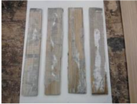
Ilustración 33 probetas de guadua conglomerada con resina Epoxi
