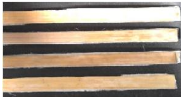
Ilustración 39 de probetas, conglomeradas con resina Epoxi 250 mm de longitud x 20mm ancho y 3mm de grosor.
