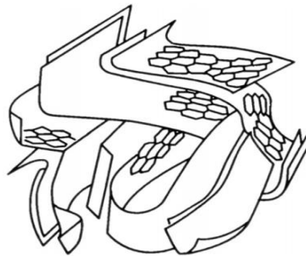
Ilustración 2. Representación esquemática de la microestructura de un carbón activado tomado de: Rodríguez & Silvestre, 2016)
