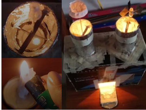
Imagen 17. Relación calor trabajo en la Heat Wizard. Esta imagen refleja la combustión de la vela, la observación interna de la vela dentro de la máquina y la rotación de las hélices a raíz del calor que se convierte en trabajo mecánico. Imagen propia 2024.
