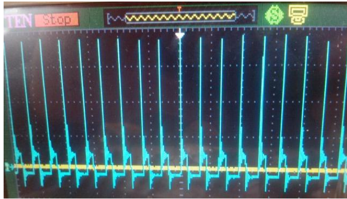
Figura 9.9: Picos generados en el transformador por componentes de corriente continua no eliminados
