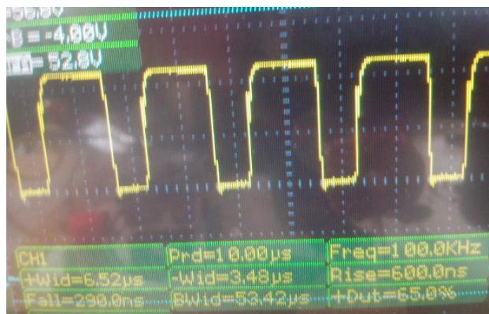
Figura 8.5: Señal del IGBT del lado alto con ayuda de la red Conmutando con ayuda de la red Bootstrap
