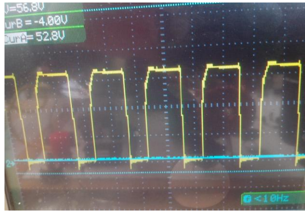
Figura 8.6: señal de voltaje del Inductor
