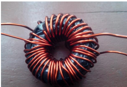
Figura 9.8: transformador Toroidal de alta frecuencia Implementado
