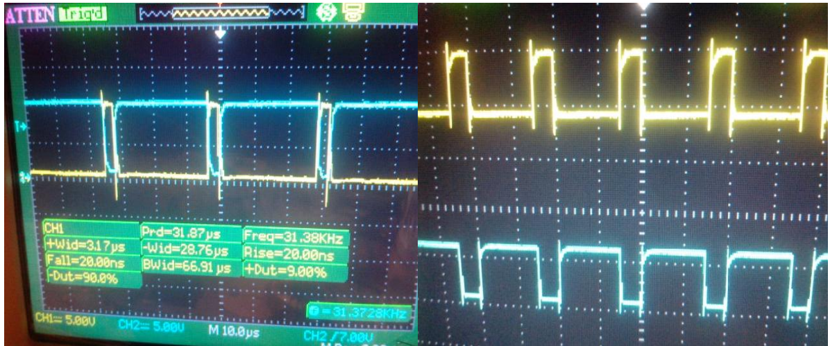
Figura 9.4: Señal de desfase generada por el IR2110
