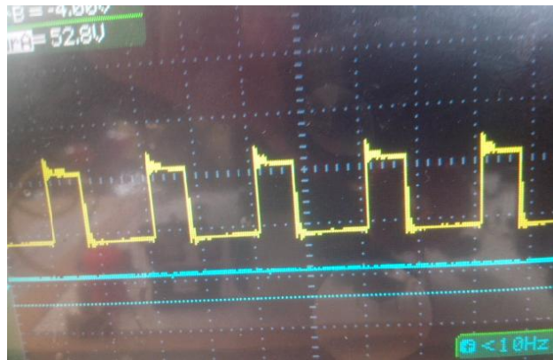
Figura 8.7: Señal de voltaje del diodo del modo Buck
