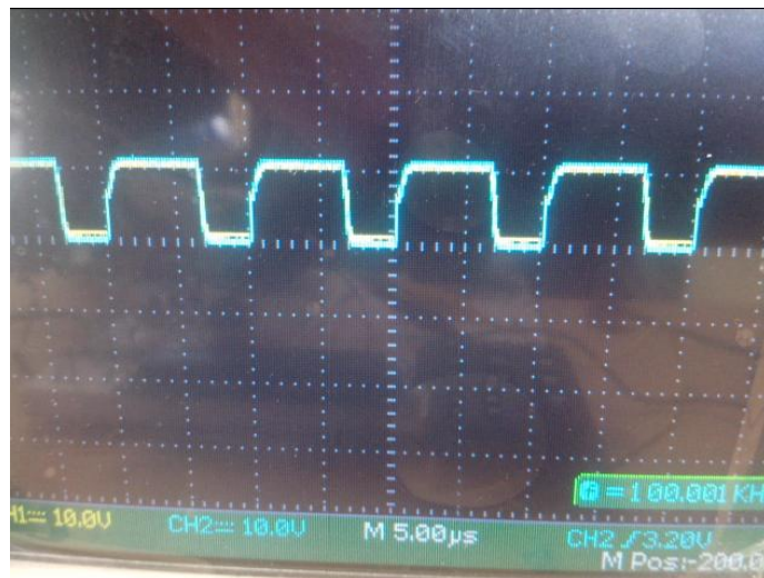
Figura 8.4: señal de compuerta de los dos IGBTs
