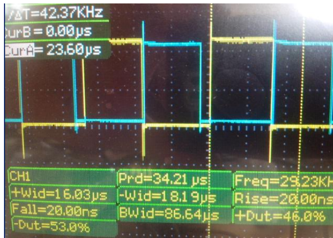
Figura 9.5: Señal de compuerta de los dos driver de lado alto sin conmutar
