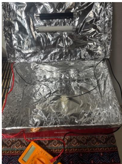
Imagen 9: Cámara oscura con el recipiente contenedor del sulfato de hierro conectado por medio de cables a la fuente de electricidad y el multímetro.
