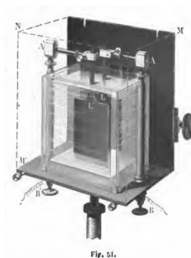
Imagen 3: Actinómetro electroquímico desarrollado por Edmond Becquerel. (Becquerel, 1868)
