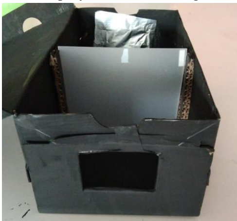
Figura 6. Cámara estenopeica Fuente Elaboración del autor
