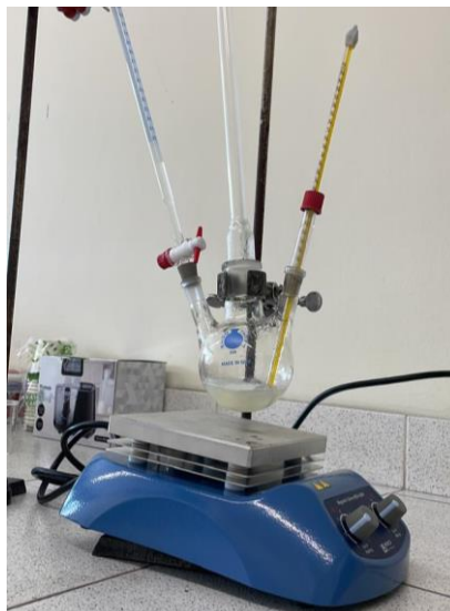
Figura 5. Montaje para la síntesis de NPs. Fuente: Elaboración propia.
