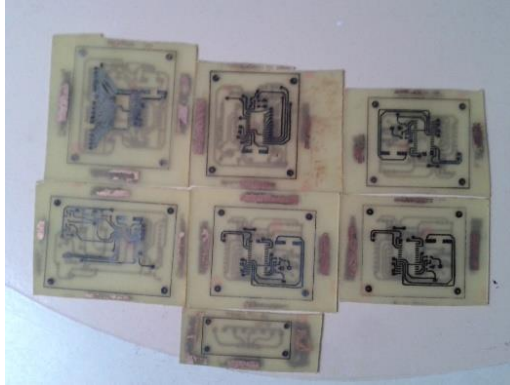
Imagen 32: Baquelitas después del proceso del ácido
